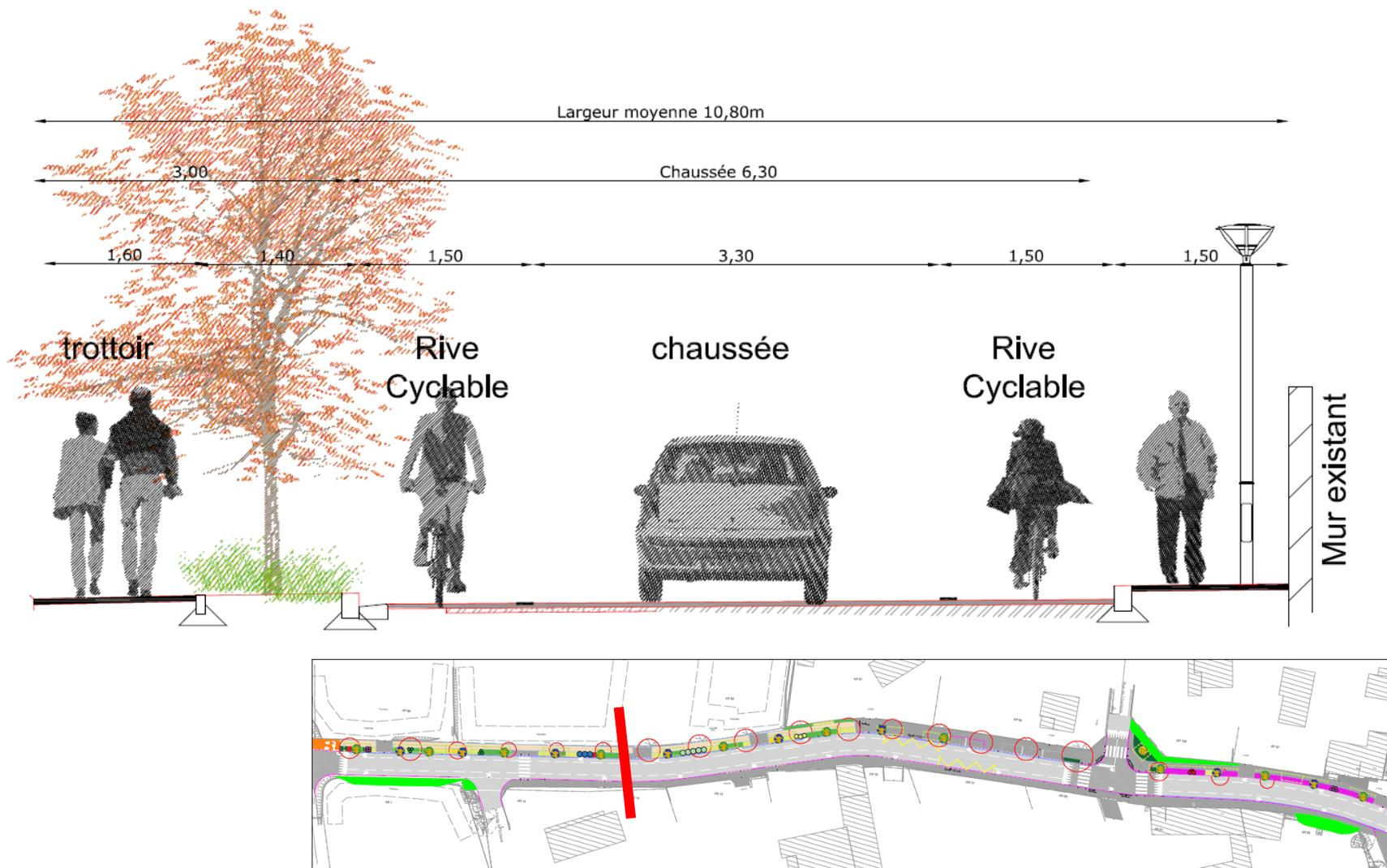
■ **Fonctionnement chaussée à voie centrale banalisée**
